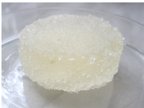
Рис. 3. Высушенная эмульсия, стабилизированная 5 %-м аэросилом с 0,1 М гексиламином. Органическая фаза – оливковое масло
